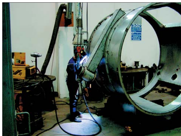
4 - saldatura esterno apparecchiature
