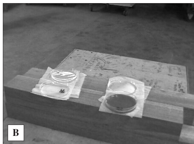
Figura 1. A), campionatore ad impatto ortogonale SAS; B) piastre per il campionamento passivo IMA
